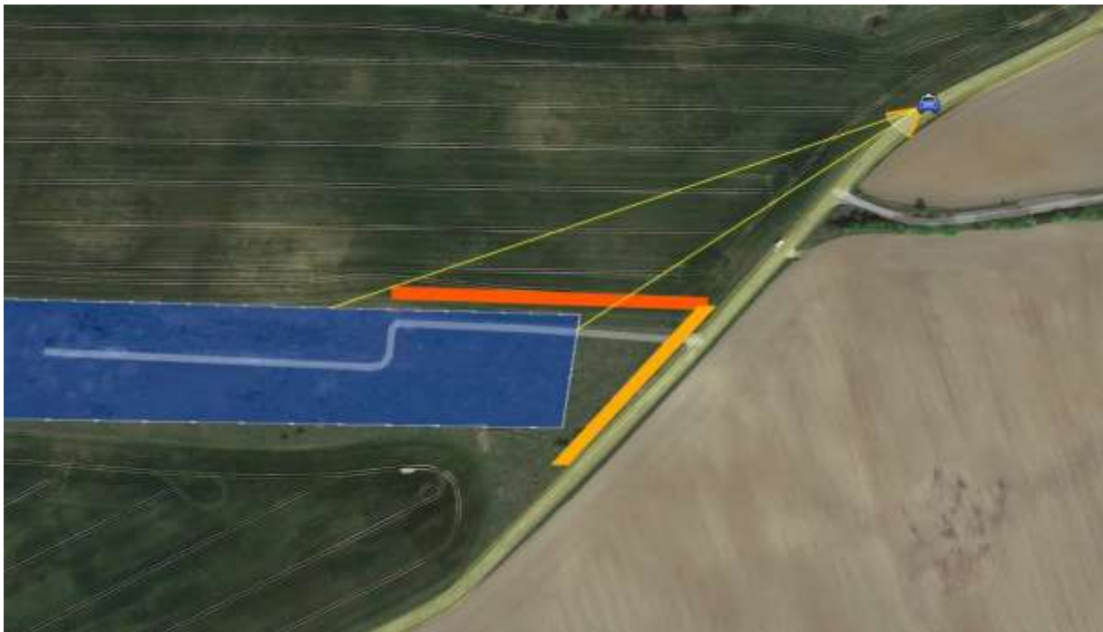
Abbildung 15: Potenzielle Blendung ausgehend von PV – Fläche Ost 1 auf die Kreisstraße UER5. Blau dargestellt ist die PV – Fläche, hell-orange markiert der Bereich, für den ein Wall geplant ist, dunkel-orange der Bereich, der die notwendige Länge des Sichtschutzzauns darstellt und die gelben Linien, die die Reflexionswinkel, ausgehend vom Solarpark, verdeutlichen“
